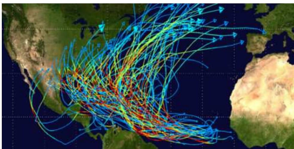
**Figura 3.5.-** Cien trayectorias sintéticas de huracanes atlánticos, generadas mediante la técnica descrita. El color da idea de la intensidad máxima de los vientos alcanzada.
